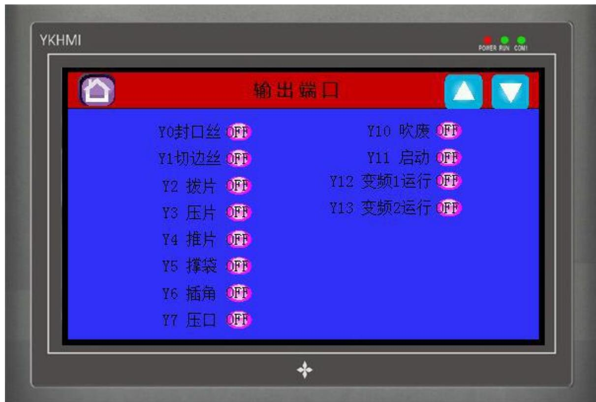
包装机由 PLC 控制各个电磁阀，再由电磁阀驱动各个气缸。该画面用于判断各电磁阀是否按程序设定的顺序动作。
