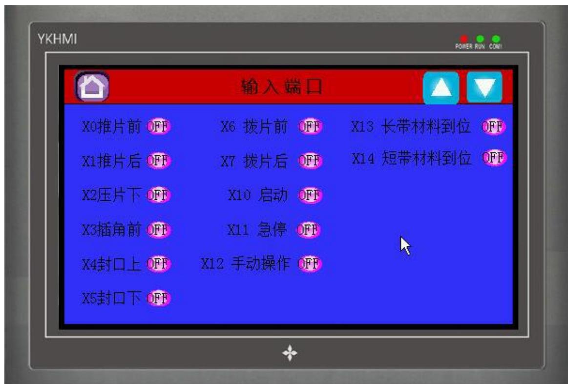
包装机由多个气缸组合完成装袋操作，多个气缸装有传感器以检测气缸的行程是否到位。如果气缸动作到位则会被相应的传感器检测到，传感器检测到气缸动作到位后传感器的指示灯会被点亮。如果气缸动作到半途中停止时，检查动作过程中的最后一个气缸是否动作正常到位的主要判断依据就是传感器的指示灯是否被点亮。
