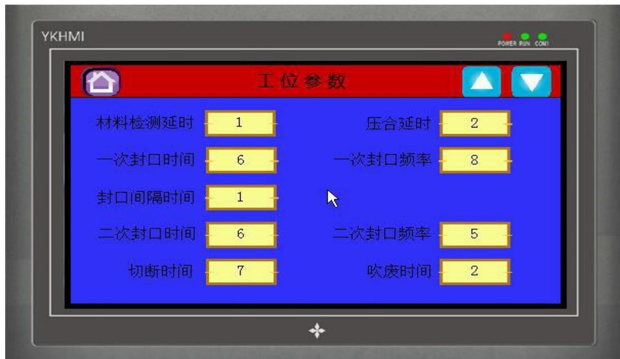
5.2.2 点击各数字框
